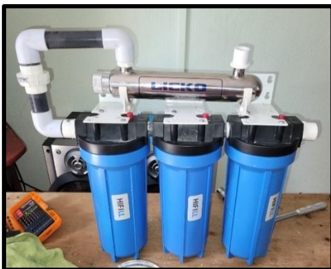
Confección del filtro de agua potable de sedimentos y carbón
