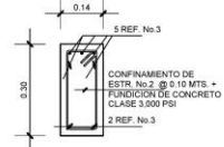
SECCION "B-B" DETALLE DE VIGA MOJINETE ESCALA: 1/10
