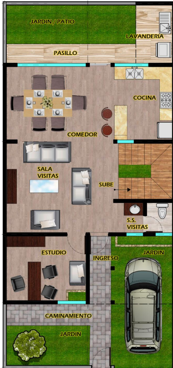
PLANTA ARQUITECTONICA PLANTA BAJA ESC: 1/75
