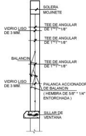
SECCION C-C: Ventana ESCALA: 1/10
